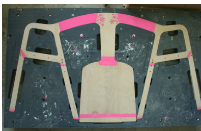
Reperetele și materialul elastic după injectare în matrită
